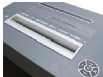
Kontrolky zapnutí, plného koše a zaseknutého papíru
